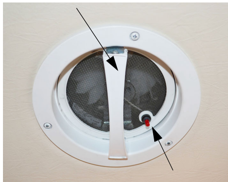
Fan Power Switch
